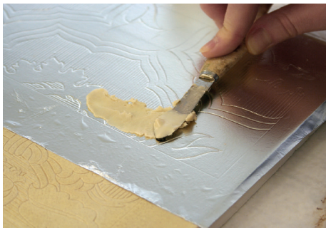
Auftrag der Prägemasse auf die Zinnfolie
